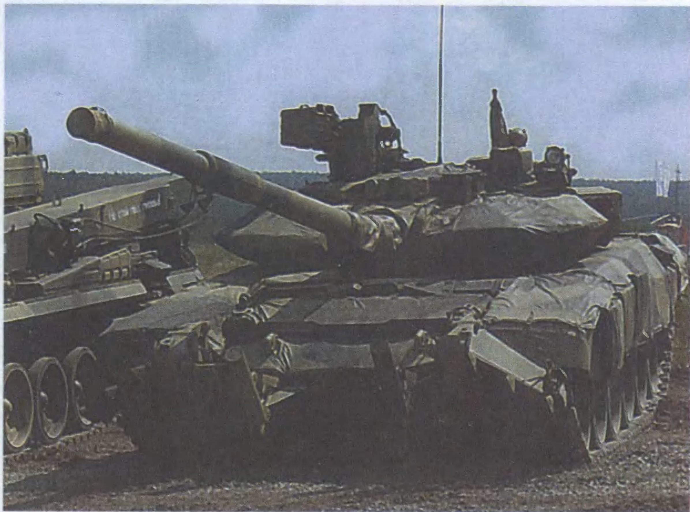
Танк-«невидимка» Т-90С, снабженный комплексом «Накидка» и колейным минным тралом КМТ-8. Систему электромагнитного разминирования не видно под защитной накидкой.
